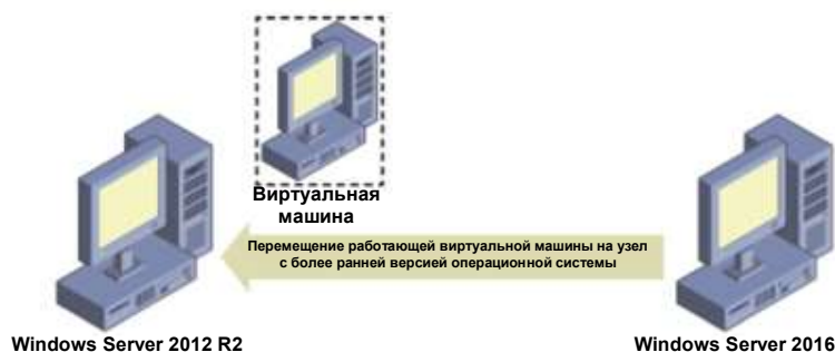
Рис. 2-10. Перемещение виртуальной машины с узла Windows Server 2016 на узел с более ранней версией Windows Server
