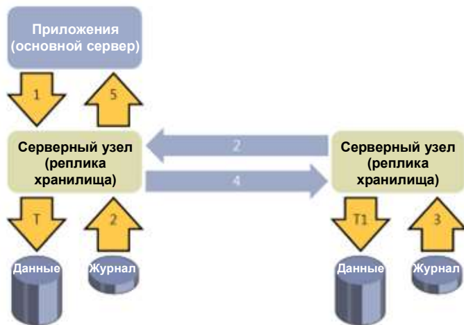
Рис. 2-51. Синхронная репликация при использовании реплики хранилища
