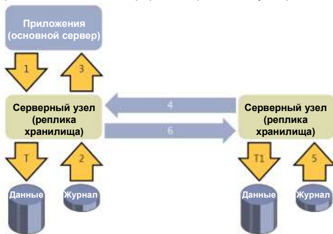
Рис. 2-52. Асинхронная репликация при использовании реплики хранилища
