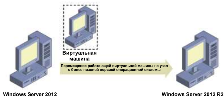
Рис. 2-9. Динамическое перемещение с узла версии 2012 на узел версии 2012 R2
