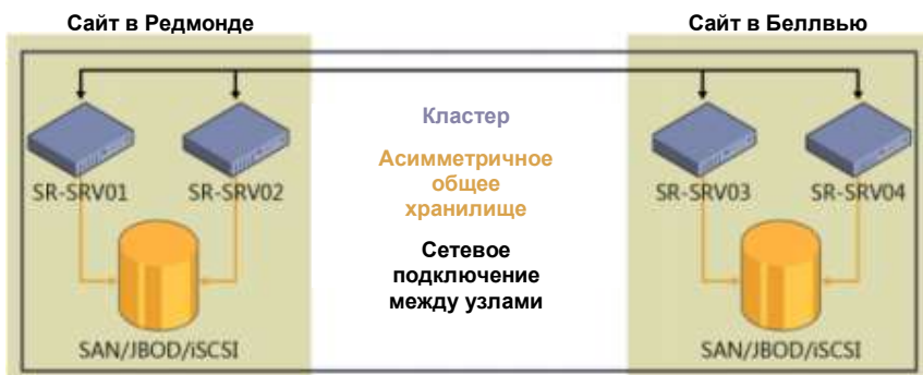
Рис. 2-53. Типовая архитектура репликации при растягивании кластера
