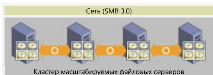
Рис. 2-59. Пример развертывания Storage Spaces Direct
