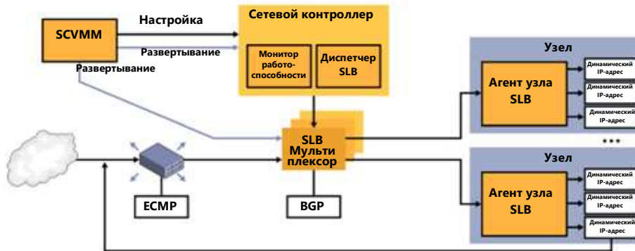
Рисунок 2-70. Общее устройство программного балансировщика нагрузки.
