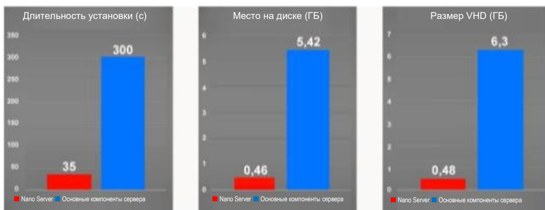
Рис. 3-4. Сравнение требований к развертыванию для Nano Server и для основных компонентов сервера (Server Core)
